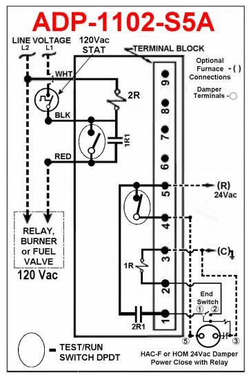
COMBUSTION AIR CONTROL DAMPER INTER-LOCKED TO LINE VOLTAGE SAFETY CONTROL CIRCUIT USING ADAPTOR ADP-1102-S5A
